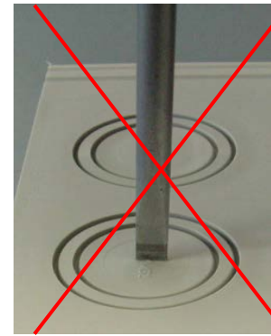
Imagen 5: Destornillador en el centro: posición incorrecta.
