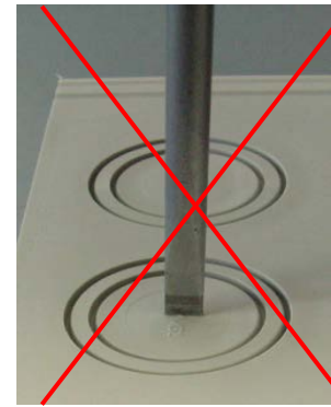
Imagen 5: Destornillador en el centro: posición incorrecta.
